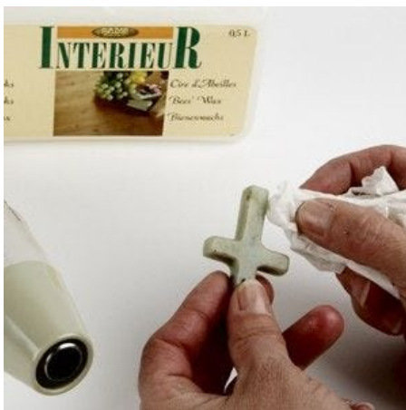
8 Verwarm het figuurtje met een warmtepistool en polijst met bijenwas, gebruik een stuk keukenrol – dit geeft een mooi glanzend resultaat.
